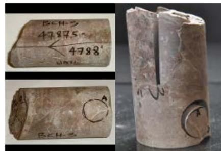
FIGURE 3: LEFT – AS RECEIVED BCH-03 CORE 4788. RIGHT – SUB-CORED SAMPLE BCH-03 4788 A.
